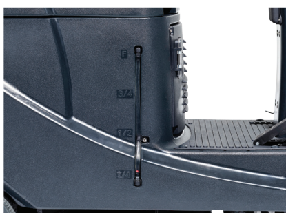
Waterniveau zichtbaar op de tank
